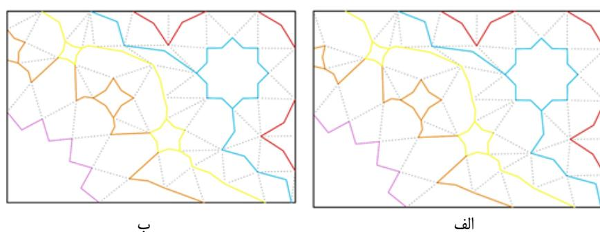
شکل ۱۳: گزینه‌های احتمالی برای مقرنس با فرض تدوره ۸ در قطار ۲؛ الف) تدوره ۴ پر روی خط نیمه، ب) تدوره ۵ پر روی خط نیمه.
